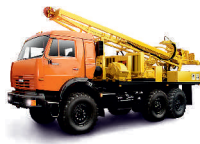
Буровая установка ПБУ-2 на базе КАМАЗ
