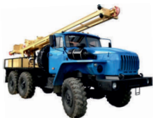
Буровая установка ПБУ-2 на базе УРАЛ 4320
