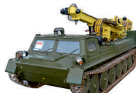
Вездеход ГАЗ-71 с буровой установкой УБШМ 1-13
