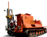
Вездеход ГАЗ 71 с буровой установкой УБШМ 1-20
